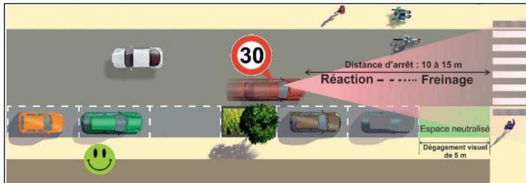
Schéma neutralisation du stationnement sur une voie bidirectionnelle limitée à 30km/h, CEREMA
