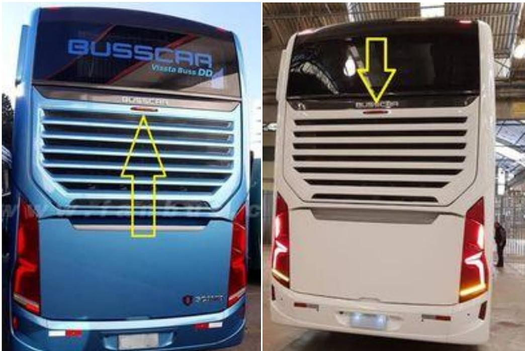
La regla alternativa "no menos de 850 mm por encima del suelo" es nuevamente inútil y contraria a la lógica, siempre que todos los conductores que conducen detrás de un vehículo comercial tengan la mirada y el campo de visión dirigidos hacia la parte inferior del vehículo de adelante, para ser capaz de ver las marcas viales en el asfalto y posibles obstáculos, por debajo de la altura de 1 metro desde el suelo.
