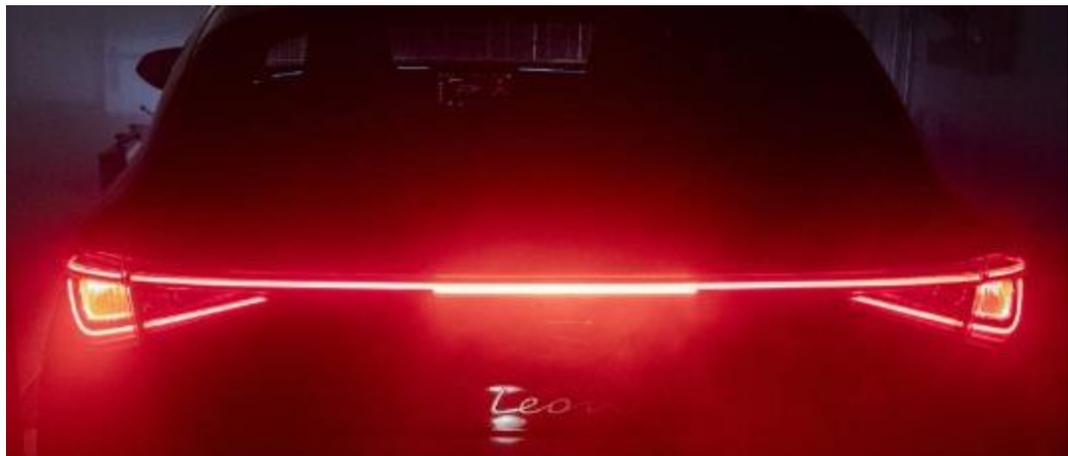
perceptible. La tercera luz de freno está en la línea común con la luz de posición. Si el conductor de este auto frena mientras miro el velocímetro, la radio, el espejo retrovisor, admiro la naturaleza o simplemente estoy distraído, estoy seguro de que perderé preciosos segundos hasta que me dé cuenta del auto que tengo enfrente está frenando.
