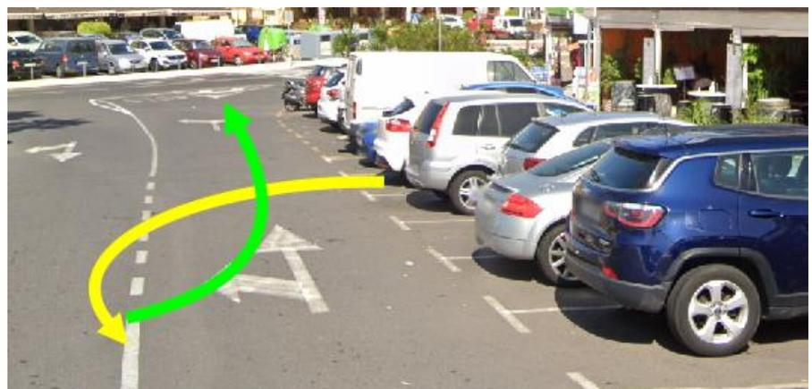
La salida y entrada del conductor al/del automóvil se realiza de manera segura desde el estacionamiento, pero el acceso al baúl para la carga/descarga de mercancías se realiza a riesgo de la presencia del conductor en la calzada, en la trayectoria de los vehículos del primer carril. Por la noche aumenta el riesgo.
