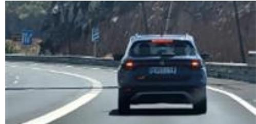
Como puede verse, las luces de este vehículo que frena apenas se ven debido a las superficies de iluminación demasiado pequeñas. Si la imagen tuviera el sol detrás, o en el campo de visión del conductor, no se habrían visto las luces de freno.
