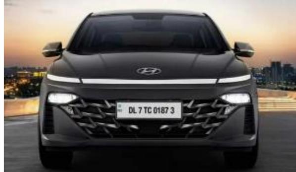
Es una buena luz para una exhibición de autos, pero en el tráfico, para un conductor que sabe que las luces de posición delanteras son 2 fuentes de luz blanca ubicadas en los extremos del vehículo, este modelo podría ser confuso y distraer la atención al otros conductores, no deseada.
