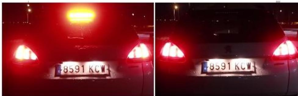
En el Opel Mokka, las luces de freno de los extremos del coche tienen una intensidad luminosa inferior a la del 3er freno, apenas visibles, y en combinación con la señalización, la distinción entre las 2 señales es casi nula.
