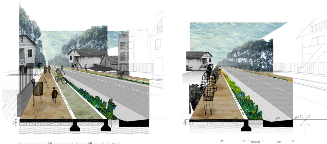
Ejemplos de acabados estéticos para sendas peatonales. A la izquierda, un caso en el que se diferencia el tráfico peatonal del ciclista, en zonas con edificación dispersa. A la derecha, ejemplo de senda compartida en zonas rústicas sin edificar.
