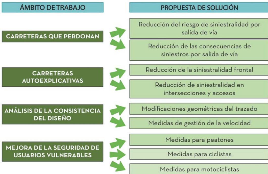
Figura 9 - Planteamiento de la Guía de buenas prácticas para la mejora de la seguridad vial en carreteras locales.
